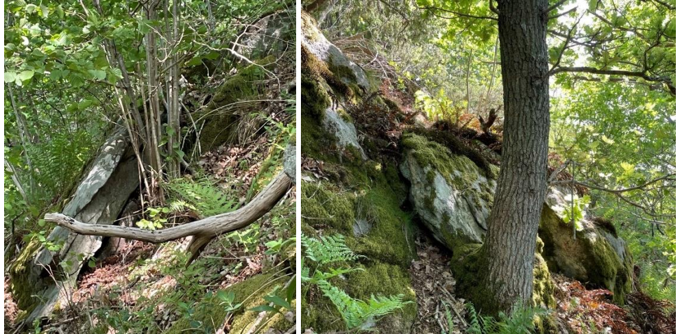
Figur 12. Lösa block i slänten i form av flak som spruckit upp längs bergets foliationsplan. Blocken åtgärdades i juni 2025.
